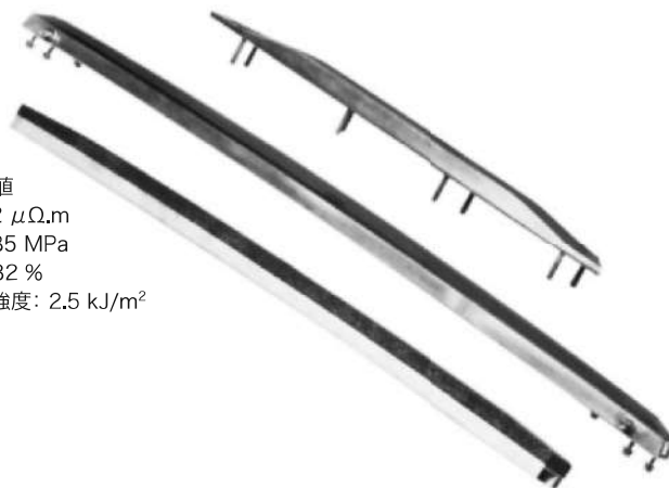
図-3 第三軌条用集電装置と第三軌条用集電靴_Ecoデザイン仕様
