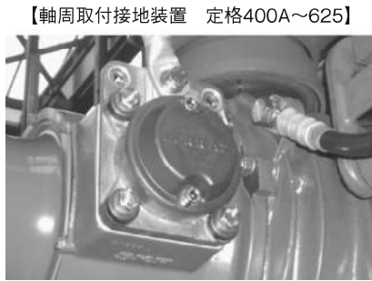
図-8 Alstom Juniper Train UK Radial ERCU 400A ~ 625A
